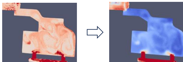
図-6 鋳物の温度分布の時間変化
