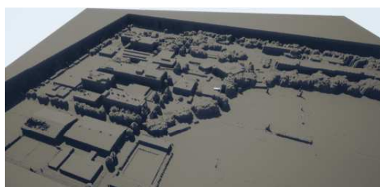
図-5 数値表層モデルを3DCGへと変換している様子
