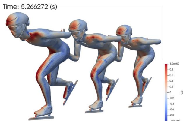
図6 パシュート競技でのスケーター前面の圧力係数
