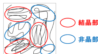
Fig.1 分子スケールにおける熱可塑性樹脂の結晶概略図
