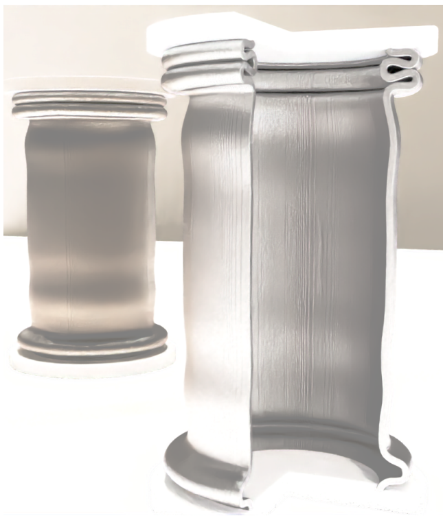
図-3 1億1324万6208個の連続体要素メッシュを用いたアルミニウム合金のクラッシュボックスの弾塑性解析結果（押込量：42mm）
