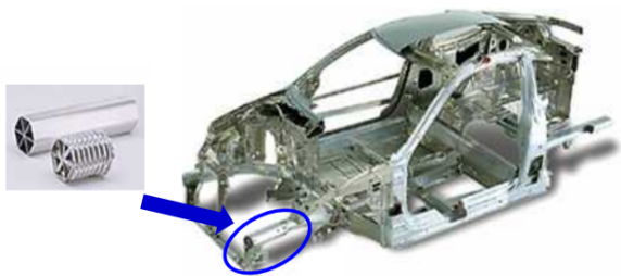
図-1 クラッシュボックスの配置図 (井出ら, 2007)
