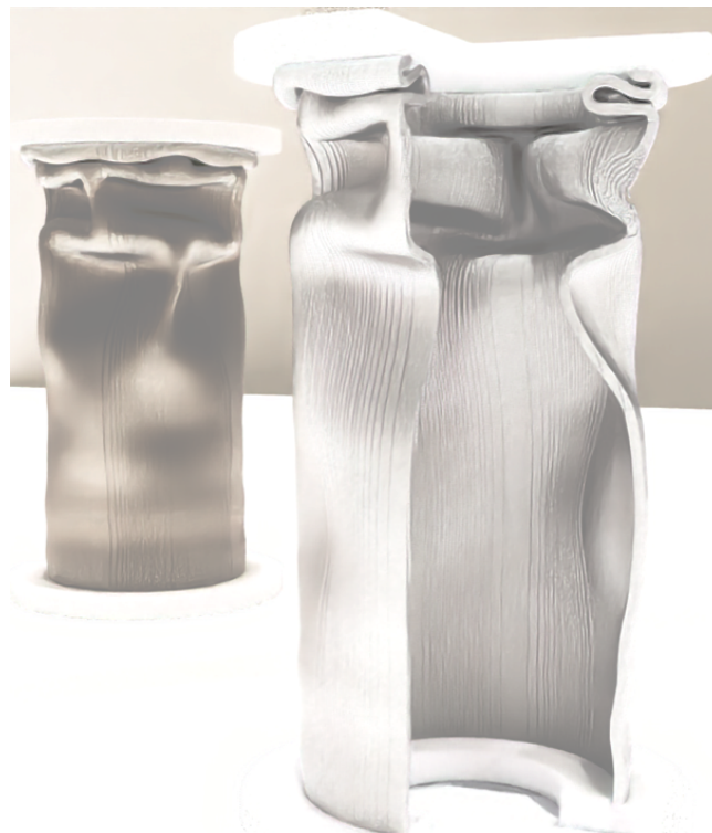
図-9 1415 万 5776 要素の連続体要素メッシュを用いたアルミニウム合金のクラッシュボックスの弾塑性解析結果：開口部がある場合
