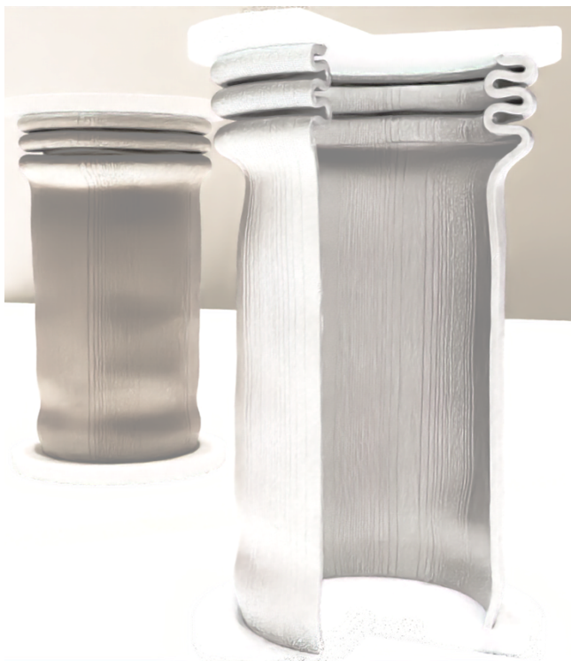
図-8 1415 万 5776 要素の連続体要素メッシュを用いたアルミニウム合金のクラッシュボックスの弾塑性解析結果：開口部がない場合
