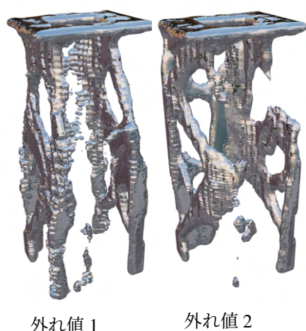
図-3 弾塑性ひずみエネルギーの外れ値に対応する 3D 形状
