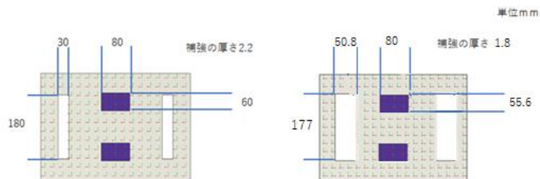
図 5 左：図 1 について，エネルギー密度位相変更法で導いた形状 固有周波数は，11.62 Hz, 22.64 Hz, 40.66 Hz, 46.00 Hz で，目標に達する．右：図 5 左のモデルから，数理計画最適化法援用エネルギー密度位相変更法を用いて，導いた形状 固有周波数は，11.66 Hz, 23.39 Hz, 40.64 Hz, 48.61 Hz
