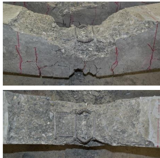
写真-1 RC はりの破壊性状
