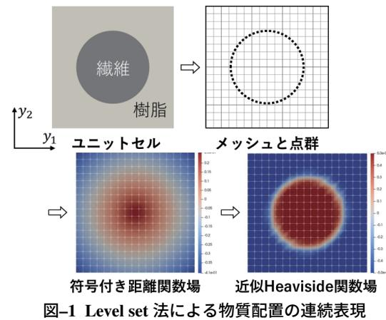
図-1 Level set 法による物質配置の連続表現
