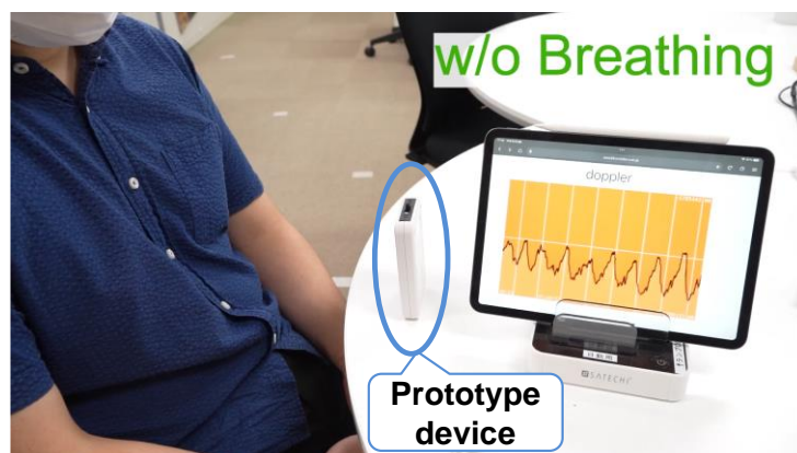
図2 マイクロ波ドップラーセンサを用いた心拍計測の一例
