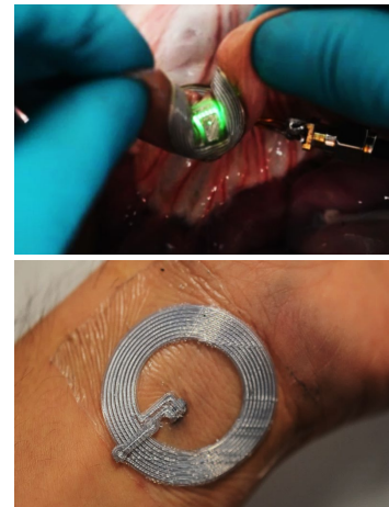
図 液体金属アンテナ からなる無線発光デバ イス(上)と IC タグ(下)
