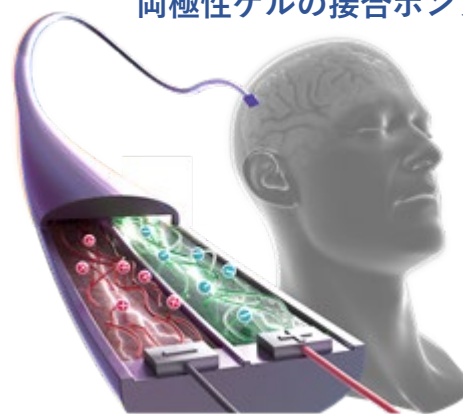
Fig. 1 ハイドロゲル製イオン트로ニック医用デバイス
