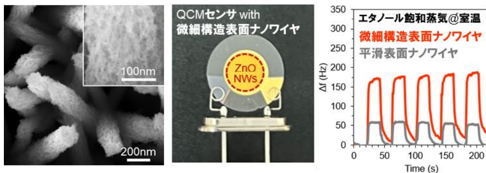
Figures: 微細構造表面ナノワイヤの SEM 像 (左図),および QCM センサへの適用結果(中央図・右図)
