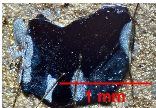
Fig. 1 溶融凝固法により育成した \text{Sr}_2\text{CoCu}_2\text{Se}_2\text{O}_2 の単結晶
