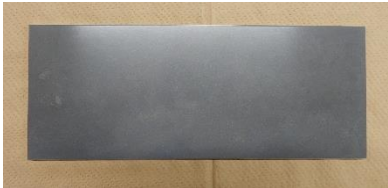
Fig. 1 280×110 mm GaN target
