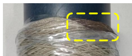
図 1 購入後に保管していた Shieldex #92 の劣化(フィルムに被覆されていない部分が着色)
