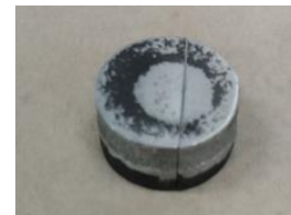
Fig. 1 Al 鑄包み手法による金属被覆処理バルク (SPS 黒鉛型付)
