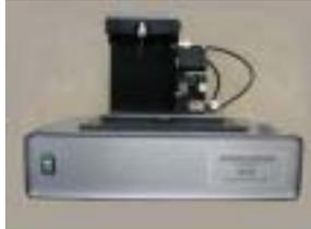
本装置は薄板の疲労を試験します。薄板の製造工程では圧延工程で薄板にしていわれています。材料の圧延された部分(表層)の組織は結晶の配向や転位などの欠陥構造が生じ、通常のパルク構造とは異なることは容易に考えられます。当然ながら圧延率や圧延回数によってできあがった薄板の組織は同一でないことも予測されます。
