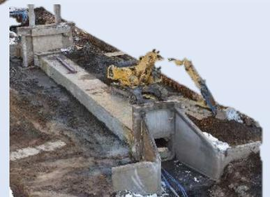
図-1 三次元モデルの作成例(SfM 解析)
