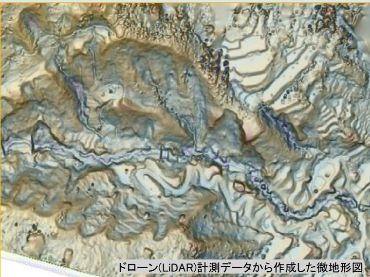
ドローン(LiDAR)計測データから作成した微地形図
