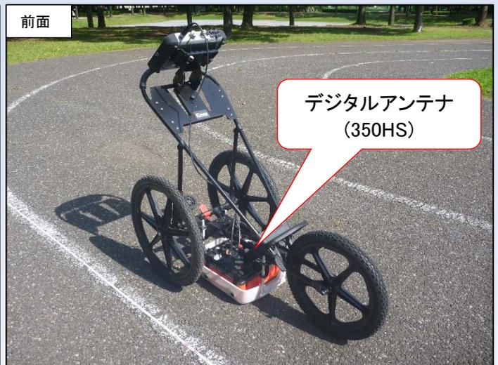
写真-2 地中レーダー探査機外観
