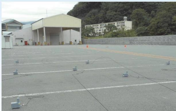
写真-2 地震計設置状況
