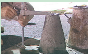
大切な材料管理、スランプ試験
