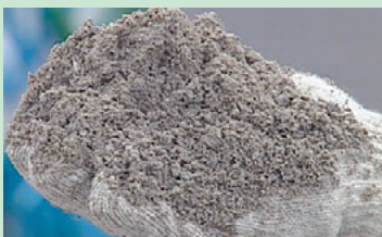
独自のノウハウによるCPG骨材
