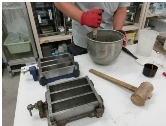
写真-1 打設状況
